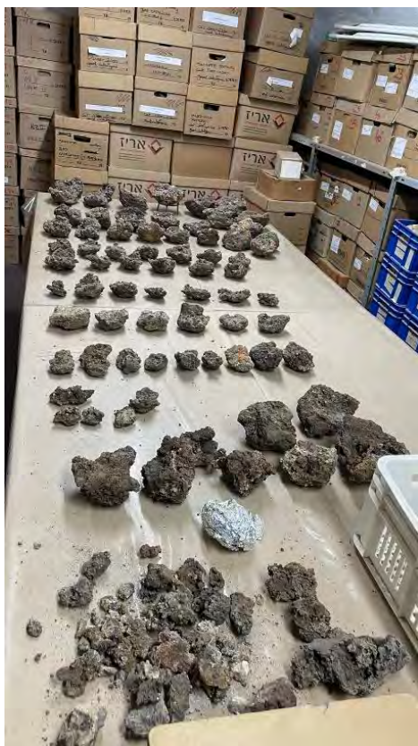
Figure 3: Classement morpho- typologique des scories de forge de Château-Pellerin dans les locaux du CRFJ
